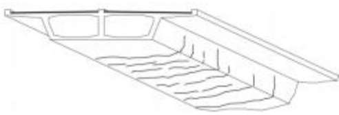
< PSC 박스거더의 균열 >
